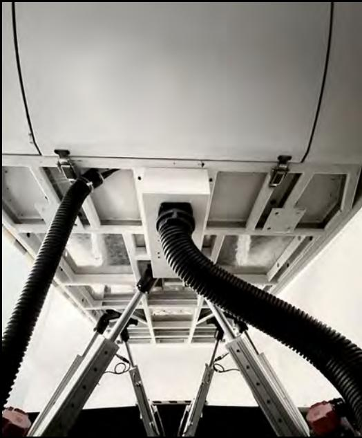
飛行模擬器設有六軸油壓平台，可以上下左右擺動，模擬出機艙內上升下降，左右側轉等不同的飛行狀態。
